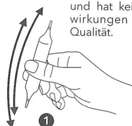
(2) Die Ampullen haben beidseitig Markierungsringe an den Enden, wo eine Sollbruchstelle vorhanden ist. Die Spitzen müssen an den Sollbruchstellen gebrochen werden. Die Lösung fließt nur, wenn beide Spitzen gebrochen sind.
